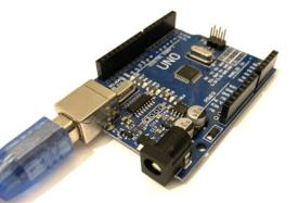
Achte darauf, dass du ein USB-Kabel verwendest, das auch Daten übertragen kann. Eine häufige Fehlerquelle für fehlgeschlagene Programm-Uploads sind tatsächlich Kabel, die nur Strom leiten – aber keine Daten.
