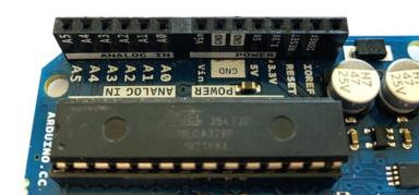
Hier haben wir zunächst Pins, die mit Power gekennzeichnet sind. Die beiden Pins GND dienen als "Minuspol" oder "Erde". Das heißt, du kannst hier beispielsweise die Kathode (kurzes Bein) einer LED anschließen, um den Stromkreis zu schließen, in dem sie sich befindet.
