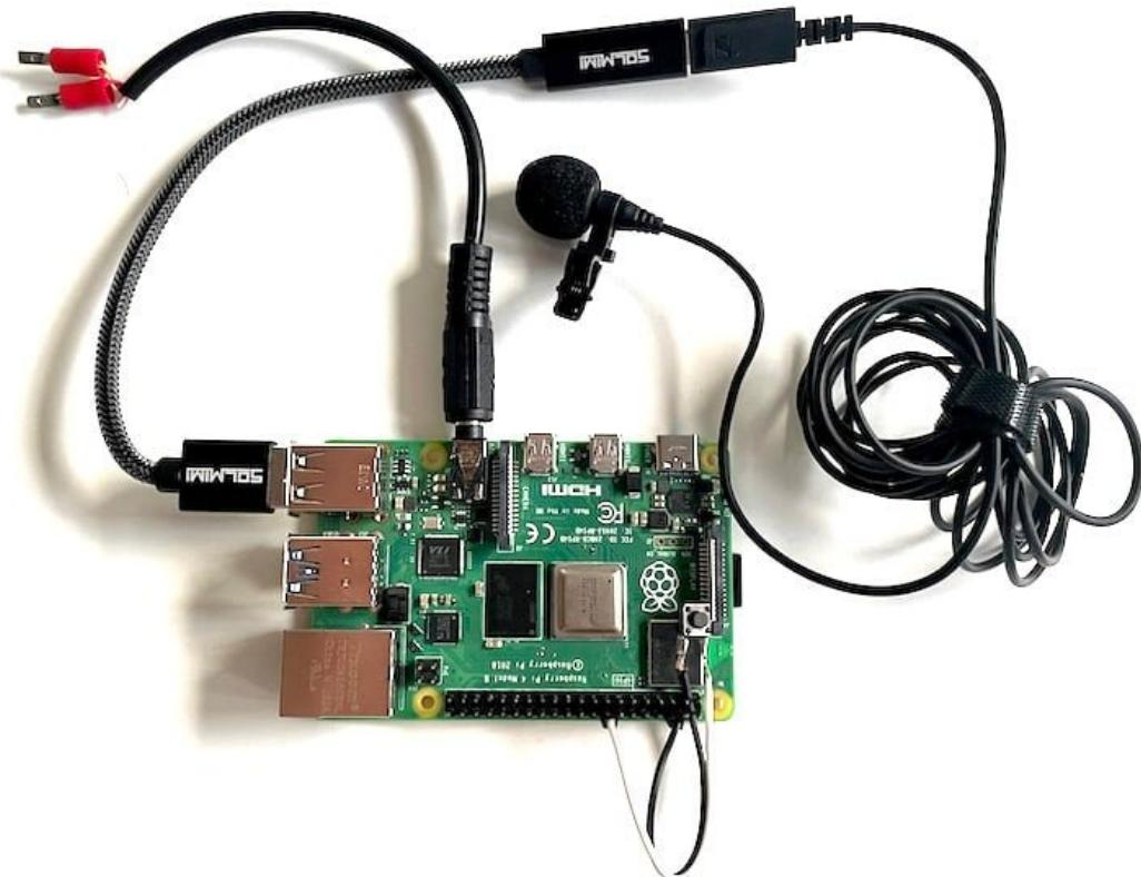
Auf der rechten Seite siehst du das Lavalier-Mikrofon. Unten an der Pin-Leiste des Raspberry Pi befindet sich ein Button, der an zwei Kabel gelötet wurde. Am Line-Ausgang (oben) befindet sich ein Klinken-Stecker, dessen Kabel in zwei Flachsteckern endet. Doch eins nach dem anderen.
