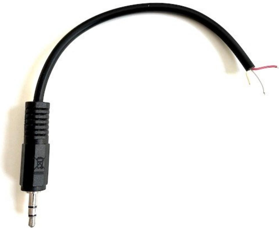
Auf dem Foto siehst du ein Stereo-Kabel, das drei Kabel beherbergt: ein rotes, weißes und gelbes. Die ersten beiden übertragen den rechten und linken Kanal, das gelbe (kann bei dir z.B. auch schwarz sein) ist die Erde. **Für den Anschluss am Lautsprecher im Hörer benötigst du die Erde und entweder das rote oder weiße Kabel.**
