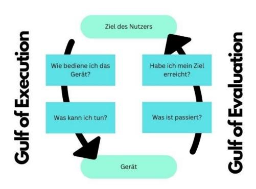
Der "Gulf of Execution" ist die Kluft zwischen dem, was der Nutzer tun möchte, und den Möglichkeiten, die unser Gerät bietet. Stelle dir einen selbstgebauten Synthesizer vor: Der Nutzer möchte einen bestimmten Sound erzeugen, aber wie? Sind die Regler logisch angeordnet? Sind die Funktionen klar beschriftet? Je größer diese Kluft, desto frustrierender die Erfahrung.
