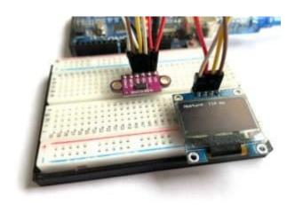
In diesem Blogartikel möchten wir Dir zeigen, wie Du ganz einfach den VL53L0X-Sensor mit Deinem Arduino UNO verbindest und verwendest. Mit diesem faszinierenden Sensor kannst Du präzise Entfernungen messen, und das mit einer Reichweite von bis zu 2 Metern.
