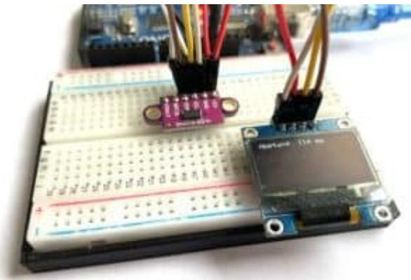
In diesem Blogartikel möchten wir Dir zeigen, wie Du ganz einfach den VL53L0X-Sensor mit Deinem Arduino UNO verbindest und verwendest. Mit diesem faszinierenden Sensor kannst Du präzise Entfernungen messen, und das **mit einer Reichweite von bis zu 2 Metern**.
