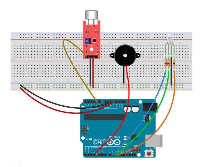
Etwas aufwändiger ist der Anschluss der RGB-LED. Insgesamt besitzt sie 4 Beinchen: eine Kathode, die du mit Minus verbindest, und drei Anoden – je eine für die Farben Rot, Grün und Blau. Wie du es von "regulären" LEDs gewohnt bist, musst du auch hier einen  $220\Omega$  Vorwiderstand einbauen – hier für jede Anode einen.
