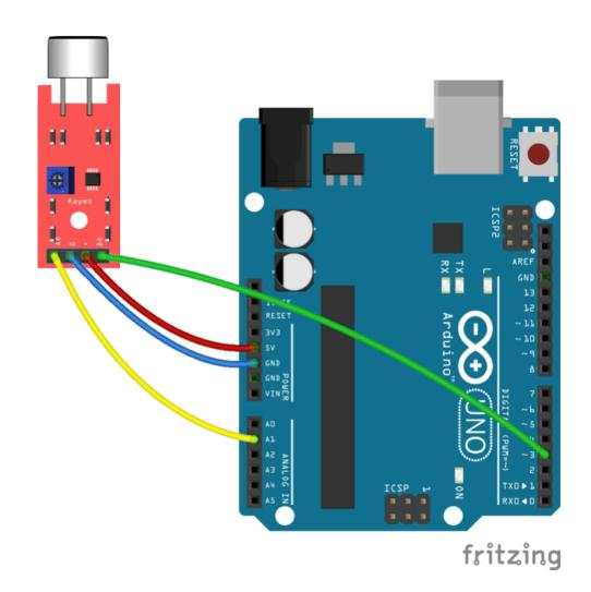
Versorge deinen Sensor mit Strom über die **Pins + und G** (für Ground, also Minus) und schließe den digitalen Ausgang (DO) am Arduino am digitalen Eingang 3 an. Den analogen Ausgang (AO) verbindest du als nächstes am Arduino mit dem Pin Al. Und das war es schon.
