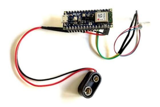
Falls du einen Arduino mit Header-Pins hast, kannst du die Kabel der beiden Bauteile entsprechend anpassen. Löte hierfür jeweils zwei Kabel mit einer Buchse an, die du dann am Arduino aufstecken kannst. Hier der Aufbau als Skizze:
